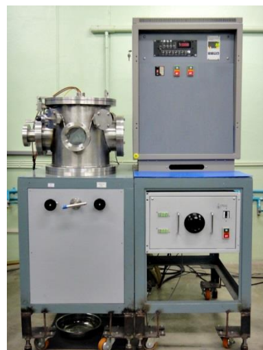
รูปที่ 1 ไดอะแกรมและลักษณะของเครื่องเคลือบในสุญญากาศในงานวิจัย
